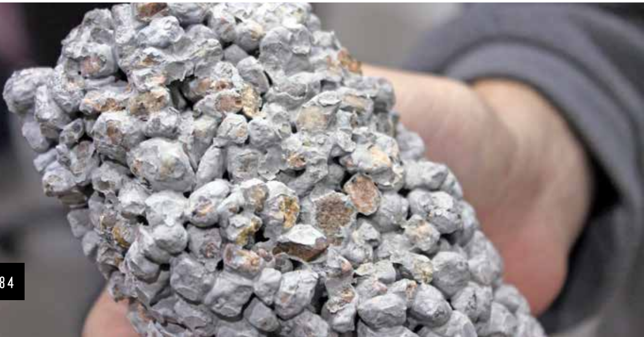
Próbka Bosta Hydrobeton® wykonana na potrzeby badań laboratoryjnych
