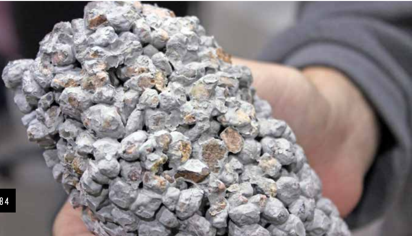
Próbka Bosta Hydrobeton® wykonana na potrzeby badań laboratoryjnych
